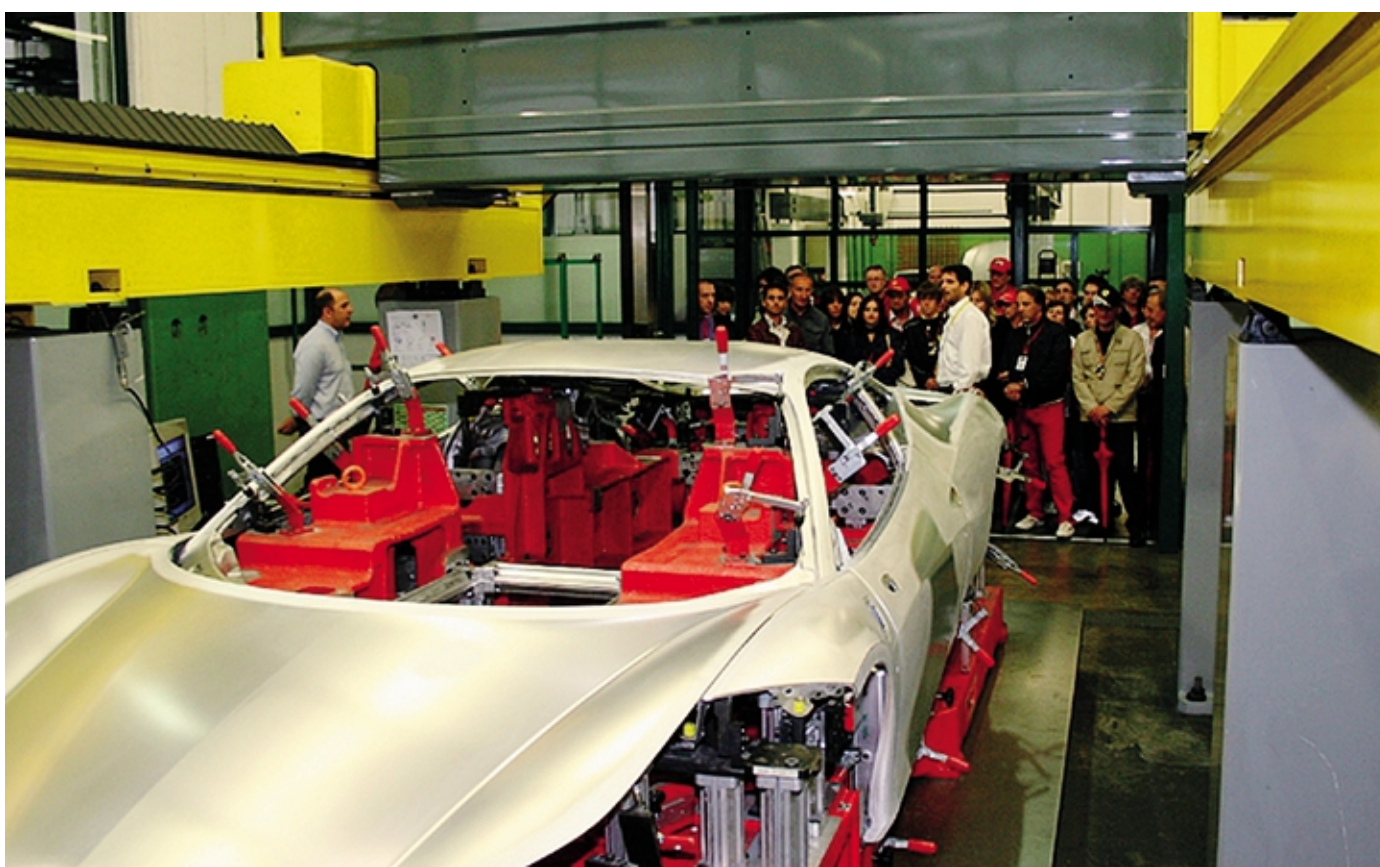
In Fontana, una fase del processo di produzione delle scocche in alluminio per le super car
