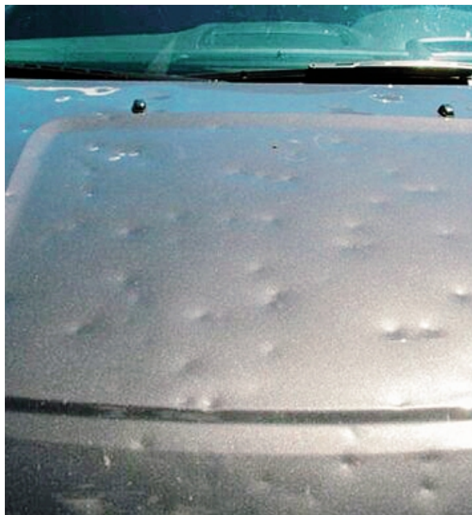
Il cofano di una vettura danneggiato dalle recenti grandinate
